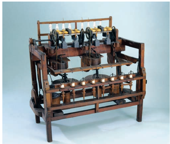
Rond 1770 ontwikkelde Richard Arkwright de eerste spinmachine die werd voortgedreven door waterkracht
